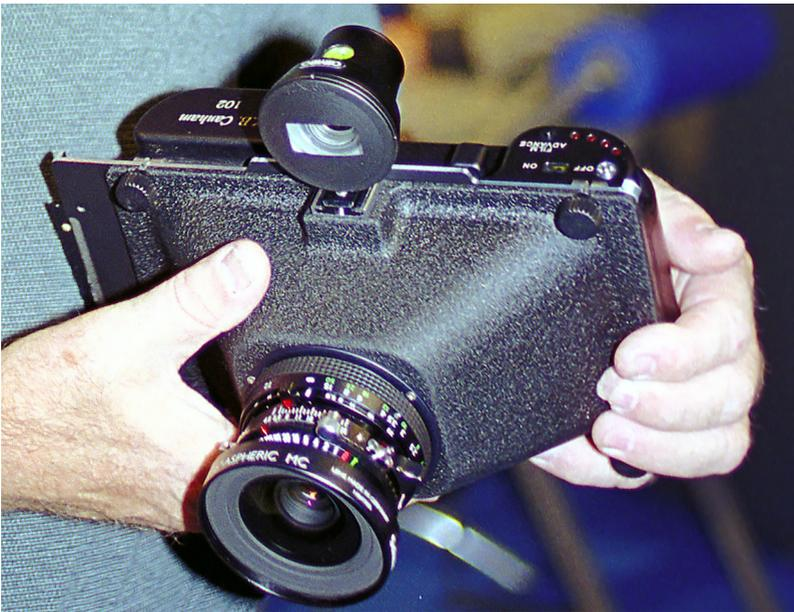
Abbildung 7: Das motorisierte ( $6 \times 17$ ) cm<sup>2</sup>-Rückteil von Canham am Prototyp der Kamera von Mike Walker.
